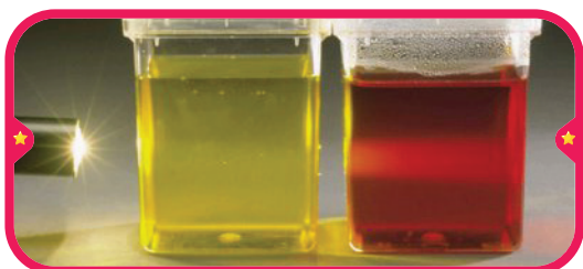
Passagem de um feixe de luz por uma solução (à esquerda) e por um coloide (à direita)
